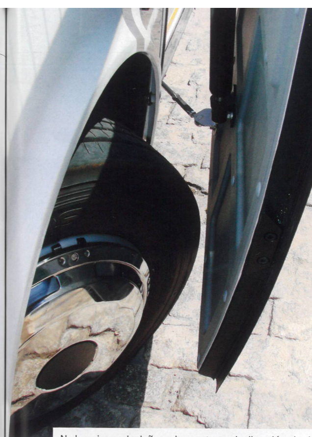
No hay riesgo de daño en la puerta con la dirección girada.
